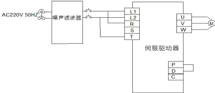
图 3-1 单相电源接线图
