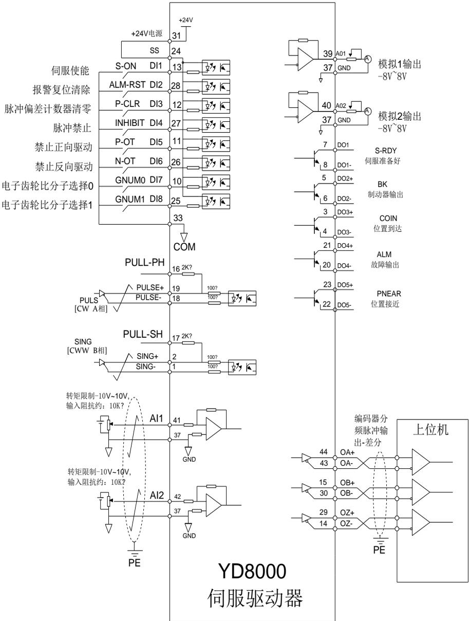
图 3-18 位置模式标准控制电路接线图
