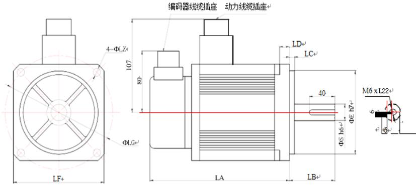
图 10-3 电机尺寸图
