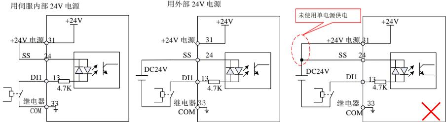
图 3-7 上级装置为继电器输出时的数字输入端子接线
