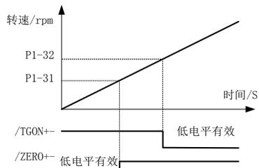
图 7-8 零速和旋转信号输出值
