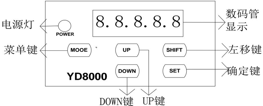
图 4-1 面板操作流程
