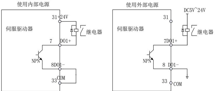
图 3-9(a) 上级装置为继电器输入时的数字输出端子正确接线
