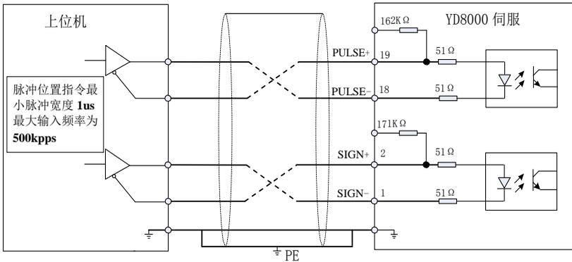
图 3-12 差分方式输入脉冲指令接线图
