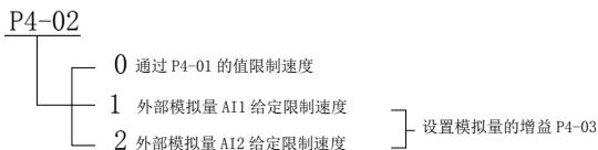
注：转矩模式时，当 P1-38（转矩限制来源选择）设定为 1/2，即外部模拟量和 P1-36、P1-37 同时限制转矩大小，同时 P4-02（转矩速度限制指令源）设定为 1/2，即通过外部模拟量
