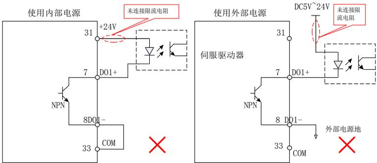
图 3-10 (b) 上级装置为光耦输入时的数字输出端子错误接线
