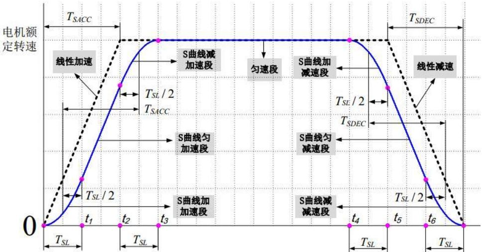
图 7-2 速度指令加减速时间及 S 曲线
