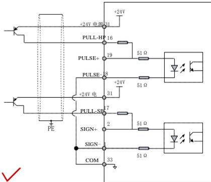
图 3-13 集电极开路方式输入脉冲指令接线图（使用伺服自身 24V）
