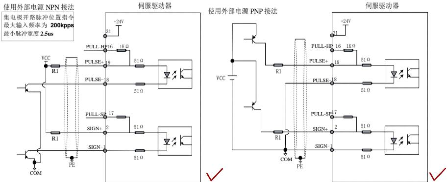
图 3-14(b)集电极开路方式输入脉冲指令接线图（使用外部电源及外接限流电阻）
