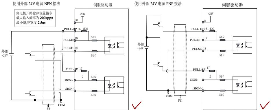
图 3-14(a)集电极开路方式输入脉冲指令接线图（使用外部电源及自身限流电阻）
