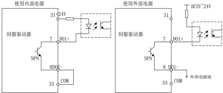
图 3-10 (a) 上级装置为光耦输入时的数字输出端子正确接线
