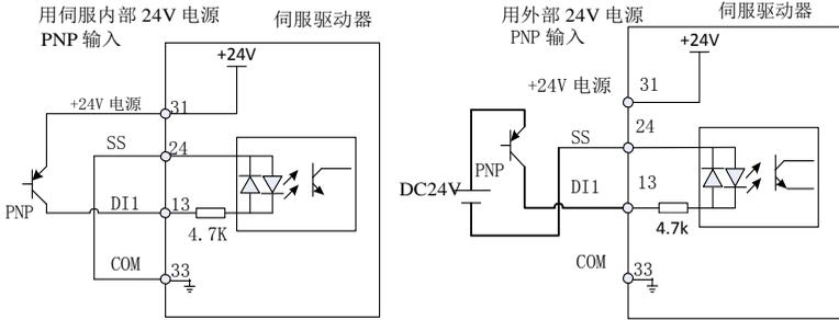
图 3-8(b) 上级装置为集电极 PNP 开路输出时的数字输入端子接线
