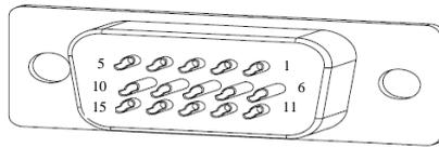
图 3-4CN3 端子焊接引脚分布
