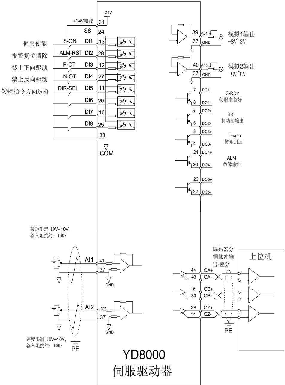
图 3-20 转矩模式标准控制电路接线图
