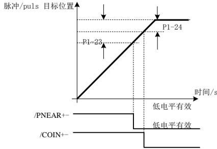
图 7-7 定位接近和完成宽度
