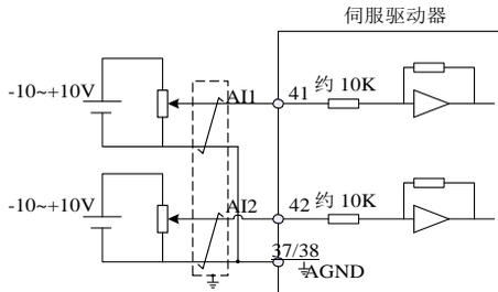
图 3-11 模拟输入端子配线图
