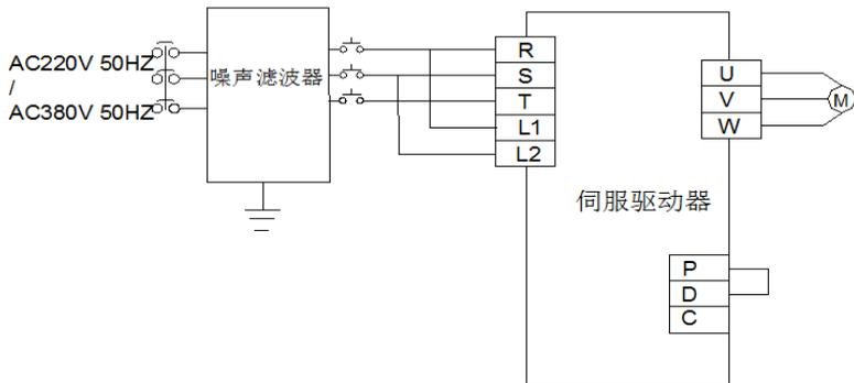
图 3-2 三相电源接线图
