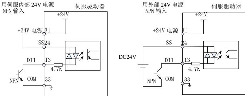
图 3-8 (a) 上级装置为 NPN 集电极开路输出时的数字输入端子接线
