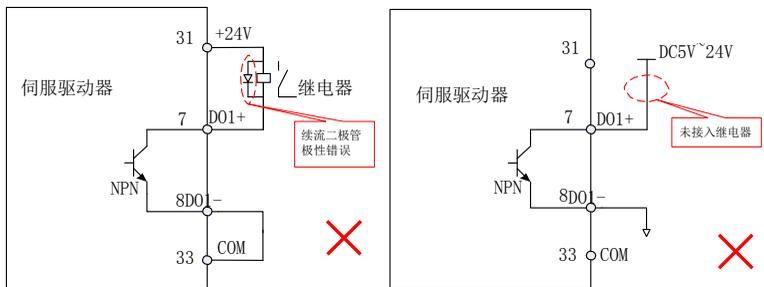
图 3-9(b) 上级装置为继电器输入时的数字输出端子错误接线
