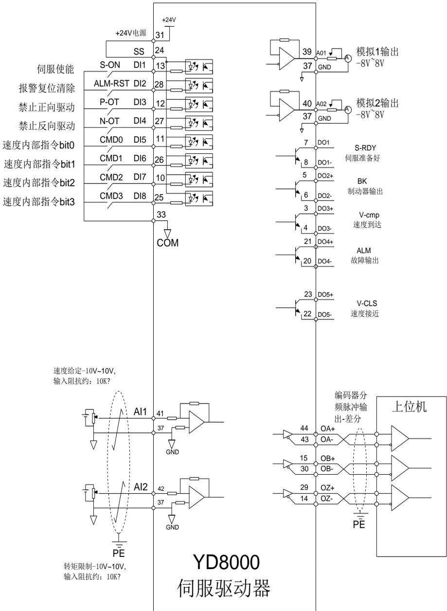
图 3-19 速度模式标准控制电路接线图
