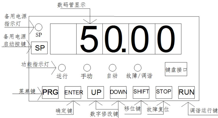
图4-1 操作面板示意图
